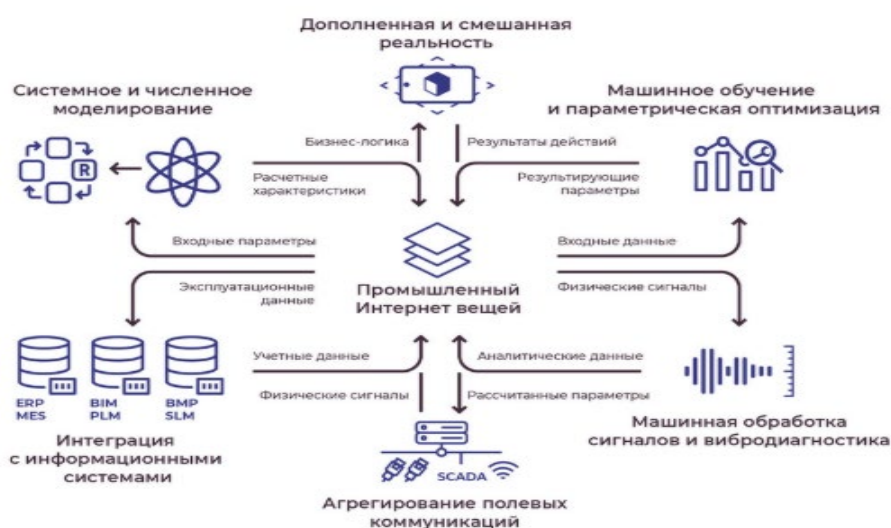
Рисунок 1. Схема работы цифрового двойника
